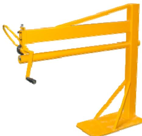
Станок предназначен для осадки фальцов лежачего типа на обечайках цилиндрической формы. Толщина листа не более 0,6мм, вылет роликов 1250мм.
